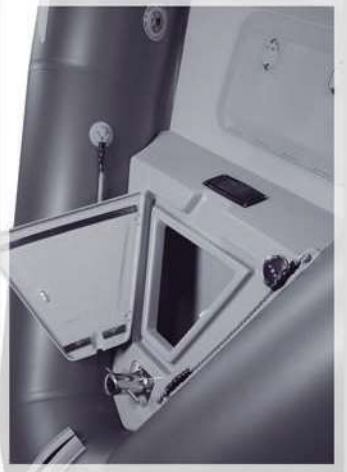
TAMBUCHO PROA C/TOMA LLENADO DEPÓSITO
